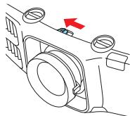
2. Faites tourner les molettes de déplacement de l'objectif horizontal et vertical sur le projecteur pour régler la position de l'image projetée.
