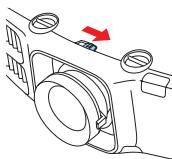
Si le projecteur est placé sur une table, vous pouvez ajuster le niveau de l'image en tournant l'une des pattes arrière réglables du projecteur.
