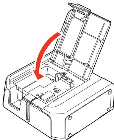
Para remover um cartucho de fita, abra a tampa, segure as laterais da fita, depois levante-a para fora da impressora.
