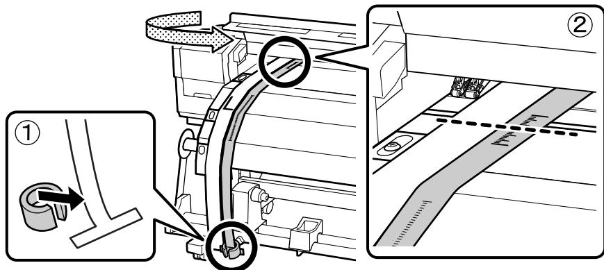
13. Levante a ferramenta de alinhamento e deslize para o outro lado da impressora, próxima à guia direita de ajuste. Alinhe a ferramenta de alinhamento e a guia de ajuste na frente e atrás da impressora.
