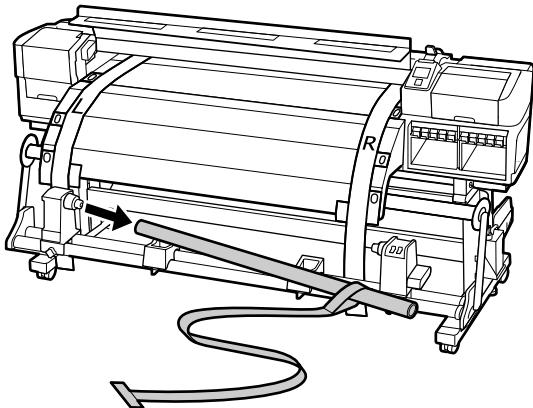
13. Retire la herramienta de alineación del portarrollos, luego retire las guías de ajuste de la impresora.
