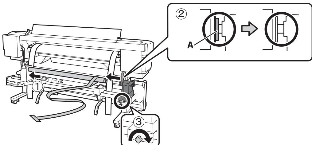
10. Deslize a ferramenta de alinhamento para o lado direito do centro do rolo e coloque para dentro da impressora.
