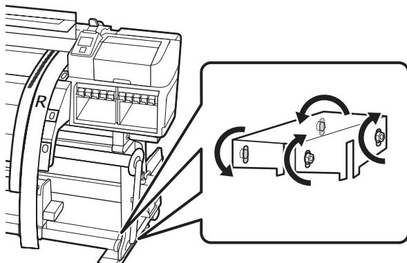
9. En la parte posterior de la impresora, retire el contrapeso de la herramienta de alineación.
