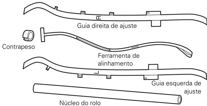
Antes de começar o procedimento de ajuste paralelo, a impressora deve estar nivelada em uma superfície plana. Desenrole cuidadosamente as guias de ajuste.
