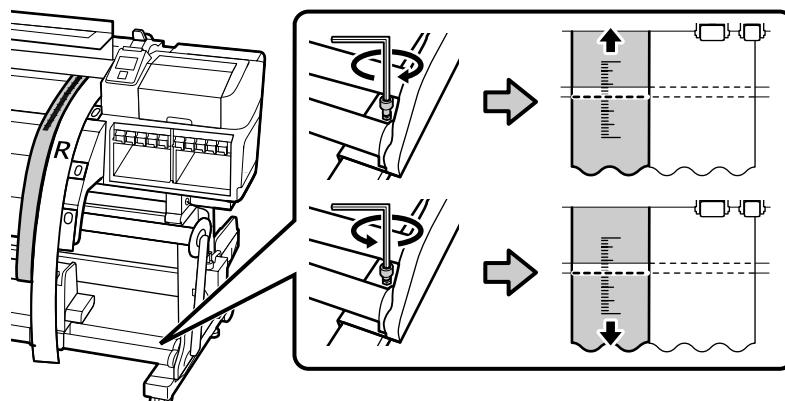
8. Apriete completamente los cuatro tornillos del soporte derecho para fijarlo en su lugar.
