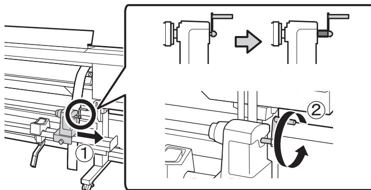
8. Deslice el portarrollos de 64 pulg. (163 cm) incluido con la impresora en el acoplamiento del extremo de la herramienta de alineación:
