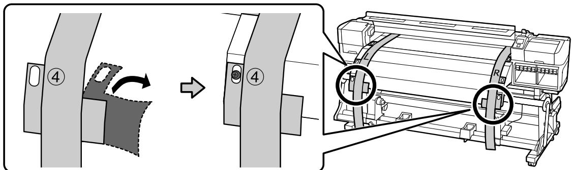
6. Atrás da impressora, alinhe o lado esquerdo do suporte de rolo com o lado esquerdo da impressora como mostrado. Depois aperte o parafuso de fixação de suporte de rolo para prendê-lo no lugar.
