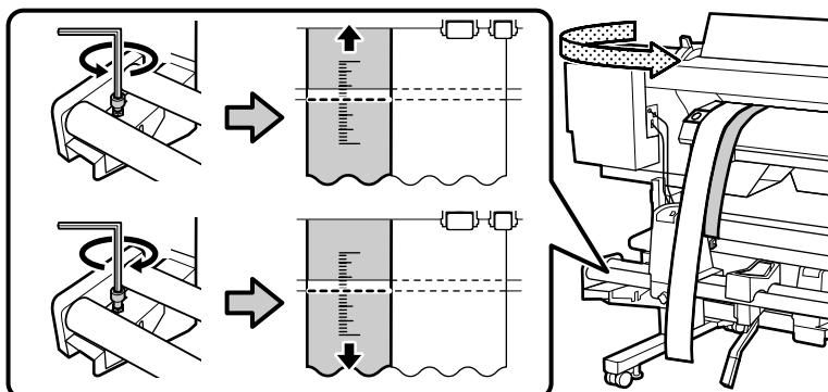
15. Apriete completamente los cuatro tornillos de montaje del soporte izquierdo para fijarlo en su lugar.
