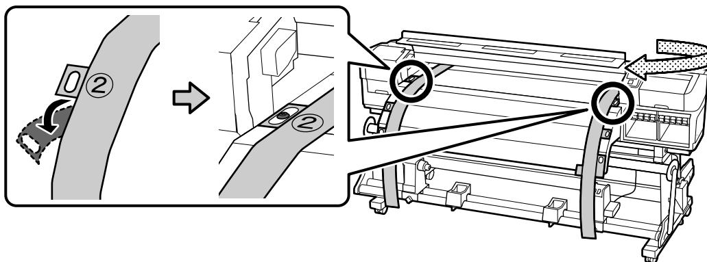
5. Coloque a guia 4 sobre os parafusos na parte de baixo do pós-aquecedor e prenda como mostrado.
