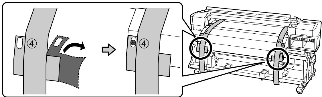
6. En la parte posterior de la impresora, alinee el lado izquierdo del tope del rollo con el lado izquierdo de la impresora, tal como se muestra a continuación. Luego, apriete el seguro del tope del rollo para fijarlo en su lugar.
