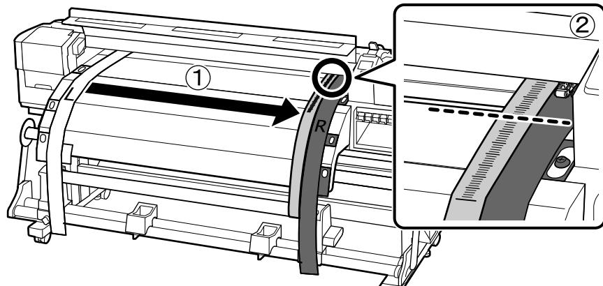
7. Todos os 4 parafusos de montagem devem estar soltos. Para fazer ajustes, gire o parafuso de ajuste no sentido anti-horário para mover a linha para trás e gire-o no sentido horário para mover a linha para frente. A linha se moverá aproximadamente 1 mm a cada volta do parafuso. Continue girando o parafuso de ajuste prata até que as medidas sejam as mesmas.
