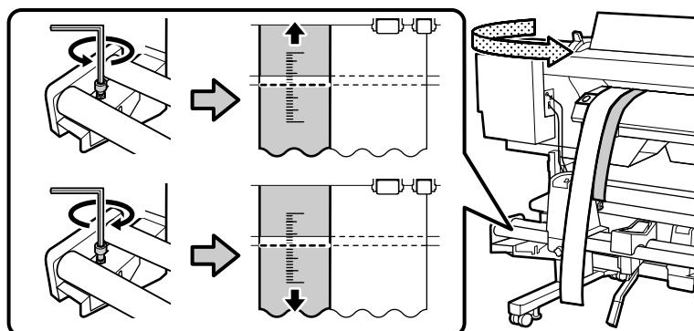
15. Aperte completamente os 4 parafusos de montagem no suporte esquerdo para prendê-lo no lugar.
