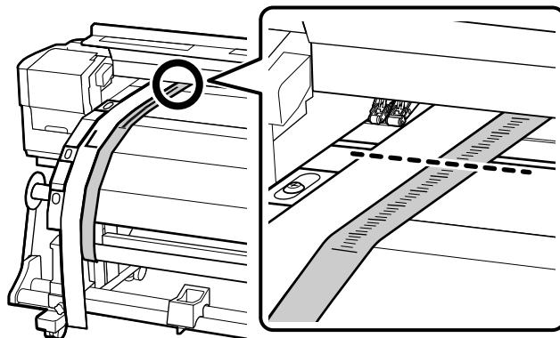
6. Levante a ferramenta de alinhamento e deslize para o outro lado da impressora, próxima à guia direita de ajuste. Alinhe a ferramenta de alinhamento e a guia de ajuste na frente e atrás da impressora.
