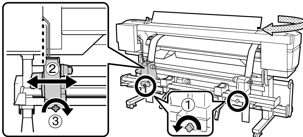
7. Si empujó hasta el fondo el eje de la manivela del tope del rollo, debe girar la manivela hacia usted (hacia la izquierda) hasta que no gire más. El eje de la manivela no debe estar colocado hasta el fondo.
