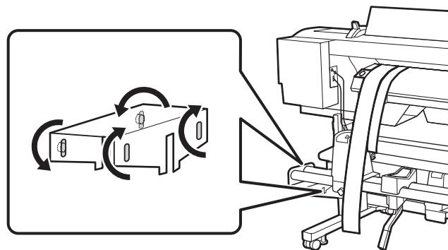
16. En la parte frontal de la impresora, retire el contrapeso de la herramienta de alineación.
