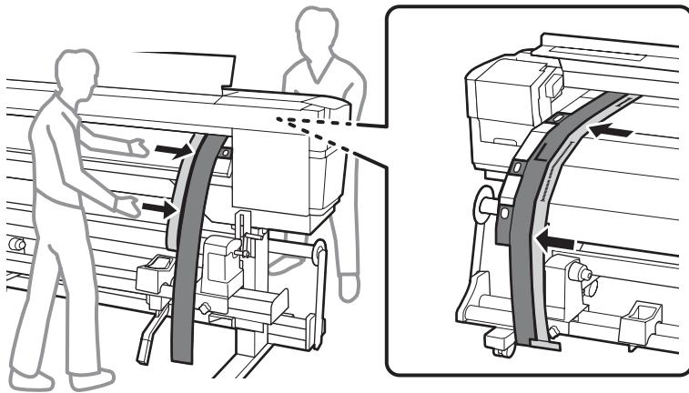
12. Prenda o contrapeso à ferramenta de alinhamento para mantê-la tensionada. Repare onde ela cruza a frente da linha branca na parte frontal da impressora.
