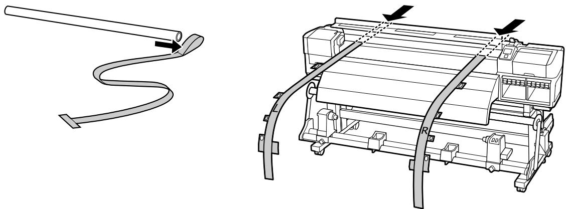
Enrolle la herramienta de alineación y las guías de ajuste y guárdelas de modo que no se plieguen. Guarde el portarrollos para usarlo en el futuro.
