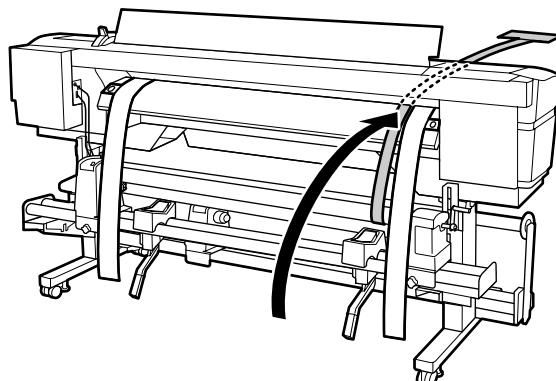
11. Coloque la herramienta de alineación junto a la guía de ajuste izquierda y alinéelas en la parte frontal y posterior de la impresora.
