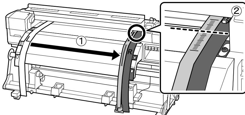
14. Todos os 4 parafusos de montagem devem estar soltos. Para fazer ajustes, mande a pessoa atrás da impressora girar os parafusos de ajuste prata. Gire o parafuso no sentido anti-horário para mover a linha para trás e gire-o no sentido horário para mover a linha para frente. A linha se moverá aproximadamente 1 mm a cada volta do parafuso. Continue girando o parafuso de ajuste prata até que as medidas sejam as mesmas.
