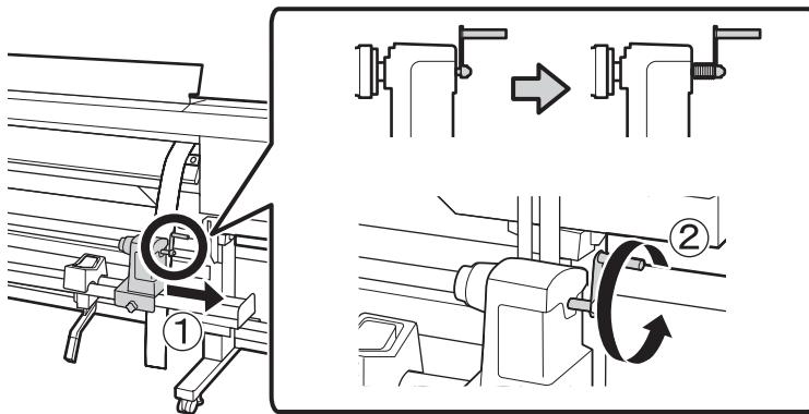
8. Coloque o núcleo do rolo de 64 polegadas (1,63 m) na alça no fim da ferramenta de alinhamento:
