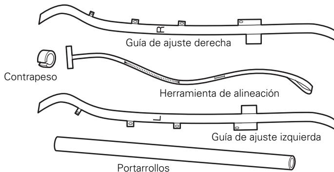
Antes de empezar el procedimiento de ajuste paralelo, asegúrese de que la impresora esté nivelada y sobre una superficie plana. Desenrolle cuidadosamente las guías de ajuste.
