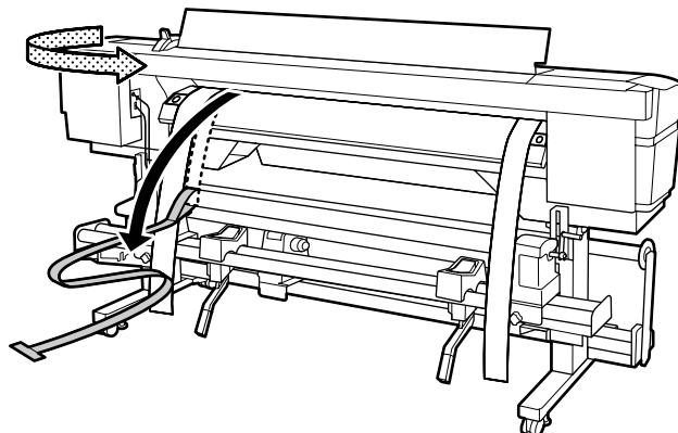
18. Afloje el seguro del tope del rollo y mueva el tope del rollo derecho.
