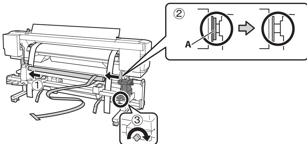
10. Deslice la herramienta de alineación hacia el lado derecho del portarrollos e introduzcala en la impresora.
