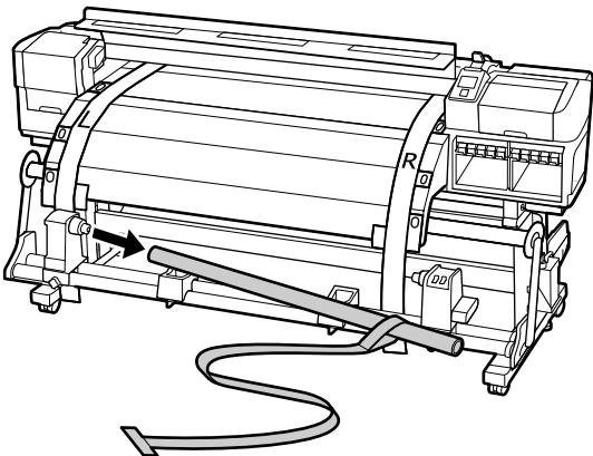
13. Remova a ferramenta de alinhamento do núcleo do rolo, depois remova as guias de ajuste da impressora.
