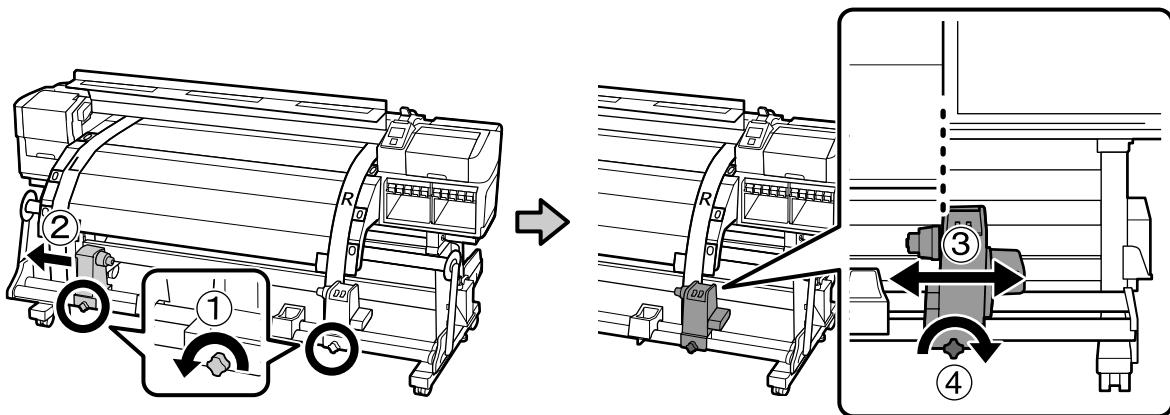
2. Coloque o núcleo de rolo com a ferramenta de ajuste no suporte de rolo:
