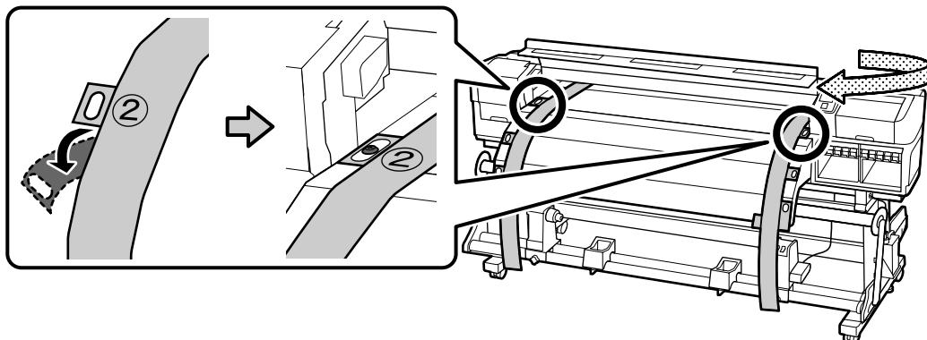
5. Coloque la lengüeta 4 sobre los tornillos en la parte inferior del post-calentador y fíjela como se muestra a continuación:
