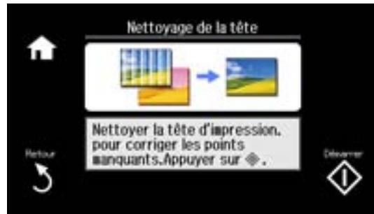
7. Cliquez sur le bouton  $\diamond$  de démarrage pour nettoyer la tête d'impression. Un message apparaît sur l'écran ACL au cours du cycle de nettoyage.
