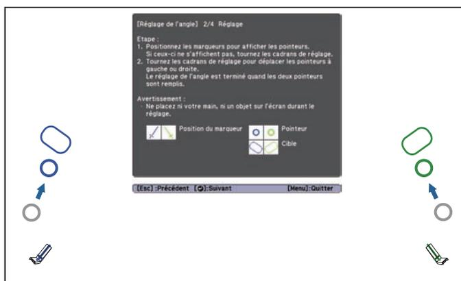
Lorsque vous tournez un cadran d'ajustement dans le sens contraire des aiguilles d'une montre, le pointeur se déplace à la diagonale vers le bas en direction du centre de l'image projetée.
