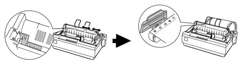
Cierre las cubiertas de las ruedas dentadas. Deslice la rueda dentada derecha y trábelala en su lugar. Vuelva a colocar la guía de papel y la cubierta de la impresora.
