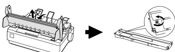
Inserte el cartucho de cinta hasta que encaje en su lugar. Guíe la cinta entre el cabezal de impresión y la guía de la cinta.
