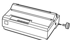
Acople el soporte del cable USB a la parte trasera de la impresora; después levántela.
