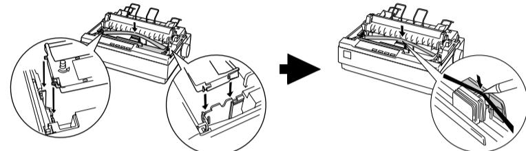
Vuelva a colocar la cubierta de la impresora y ciérrela.
