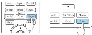
Appuyez sur les boutons fléchés de gauche et de droite de la télécommande ou du projecteur pour régler la mise au point.
