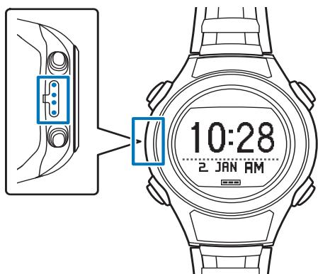
Si votre produit a de la difficulté à communiquer avec un ordinateur ou à se charger, nettoyez les points de contact du produit et le socle avec une tige de coton humide et laissez-les sécher à l'air ambiant.
