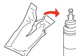
**3** Détachez l'embout de la bouteille, puis retirez le bouchon. Retirez le sceau de protection avec soin (évitez de toucher à l'encre sous le sceau), puis replacez fermement le bouchon.
