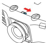
4. Si le projecteur est placé sur une table, vous pouvez ajuster le niveau de l'image en tournant l'une des pattes arrière réglables du projecteur.
