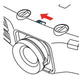
2. Faites tourner les molettes de décalage de l'objectif horizontal et vertical sur le projecteur afin de régler la position de l'image projetée.
