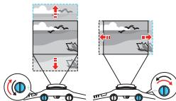
3. Lorsque vous avez fait les ajustements nécessaires, verrouillez les molettes de décalage de l'objectif.
