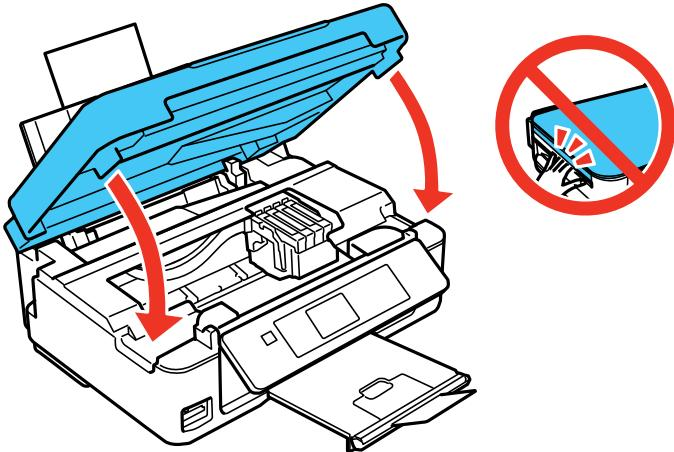
La tête d'impression se déplacera en position de repos et l'imprimante commencera le chargement de l'encre. Cela prend environ 90 secondes. Lorsqu'un message de confirmation apparaîtra sur l'écran, le chargement de l'encre sera terminé.
