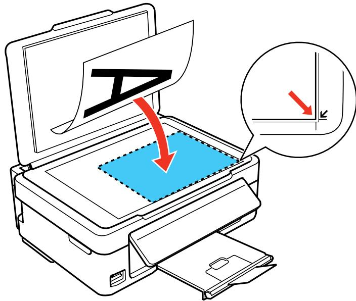
**Remarque:** Vous pouvez placer plusieurs originaux sur la vitre d'exposition du scanner. Assurez-vous que les originaux sont à au moins 0,2 po (4,5 mm) du bord de la vitre d'exposition du scanner et à au moins 0,8 po (20 mm) l'un de l'autre.
