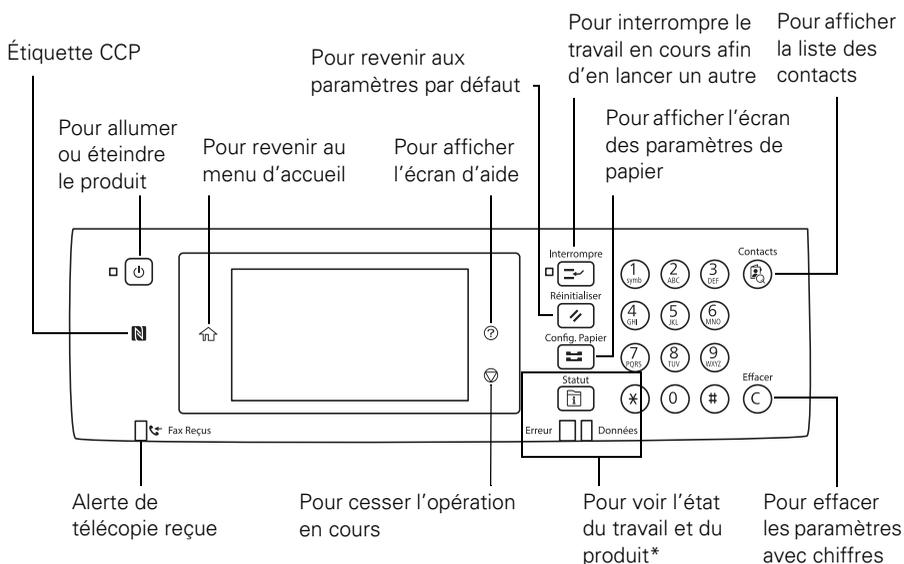
\*Le témoin Erreur clignote ou s'allume lorsqu'une erreur se produit. Le témoin Données clignote lorsque le produit traite des données et il s'allume lorsqu'il y a des travaux d'impression en attente.
