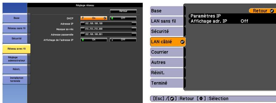
6. Réglez l'option **DHCP** à **Off** et entrez l'adresse IP, le masque de sous-réseau et l'adresse de la passerelle du projecteur, au besoin.
