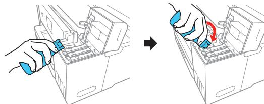
**Remarque :** Veuillez vous référer à l'autocollant des codes de couleur sur l'unité du réservoir d'encre pour identifier la couleur de chaque réservoir. N'utilisez pas de force excessive pour mettre les bouteilles en place; elles sont conçues pour s'insérer dans le bon réservoir selon la couleur.
