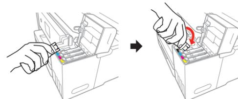
**Remarque :** Référez-vous à l'autocollant des codes de couleur sur l'unité des réservoirs d'encre pour identifier la couleur de chaque réservoir. N'utilisez pas de force excessive pour mettre les bouteilles en place; elles sont conçues pour s'insérer dans le bon réservoir selon la couleur.
