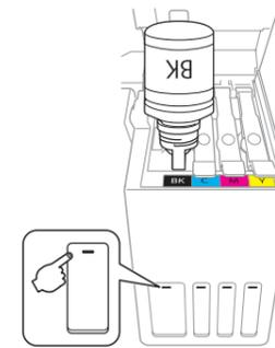
**Remarque :** Si l'encre ne s'écoule pas de la bouteille, levez et réinsérez la bouteille.
