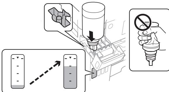
**Remarque :** Si l'encre ne s'écoule pas de la bouteille, levez et réinsérez la bouteille.
