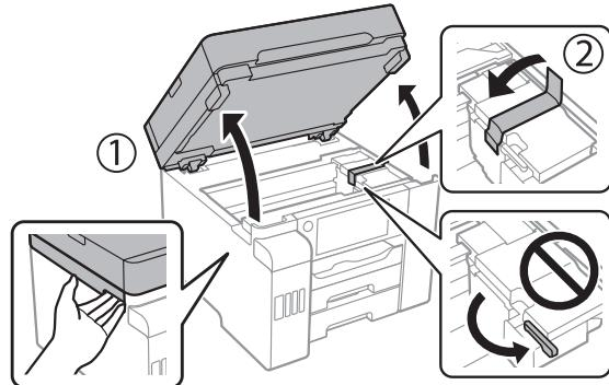
**Mise en garde** : L'imprimante est livrée avec le verrou de transport en position d'impression. Laissez le verrou en position d'impression.
