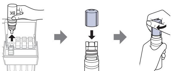
**Remarque :** Ne laissez pas la bouteille d'encre insérée; sinon, la bouteille risque d'être endommagée ou l'encre pourrait fuir.
