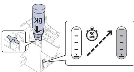
**Remarque :** N'utilisez pas de force excessive pour mettre les bouteilles en place; elles sont conçues pour s'insérer dans le bon réservoir selon la couleur.
