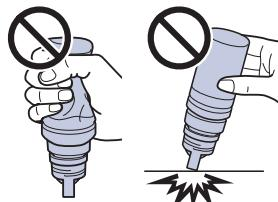
**Remarque :** L'encre s'écoule dans le réservoir et s'arrête automatiquement lorsqu'elle atteint la ligne du haut. Si l'encre ne s'écoule pas de la bouteille, levez et réinsérez la bouteille.
