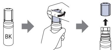
**Mise en garde :** Ne secouez pas ou ne pressez pas la bouteille d'encre. Ne touchez pas à la partie supérieure de la bouteille après avoir retiré le bouchon.
