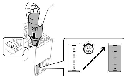
**Remarque :** N'utilisez pas de force excessive pour mettre la bouteille en place; elle est conçue pour s'insérer dans le bon réservoir selon la couleur.
