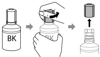
**Mise en garde :** Ne secouez pas ou ne pressez pas la bouteille d'encre. Ne touchez pas à la partie supérieure de la bouteille après avoir retiré le bouchon.
