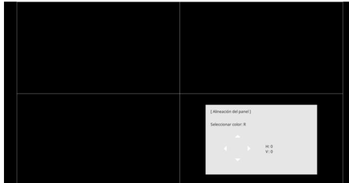
11. Utilice los botones de flecha del control remoto para ajustar la alineación del color que seleccionó para el ajuste **Seleccionar color**.
