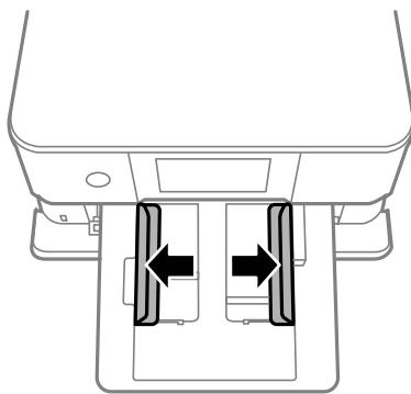
5. Insérez le papier dans le bac avec la face d'impression ou le côté glacé vers le bas.
