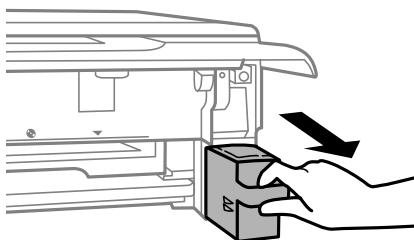
**Remarque:** N'inclinez pas le boîtier de maintenance usé et ne le démontez pas.
