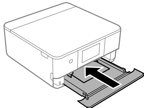
**Remarque:** Laissez suffisamment d'espace à l'avant du produit pour permettre la sortie complète du papier. Ne retirez pas ou n'insérez pas le bac papier pendant le fonctionnement de l'imprimante.
