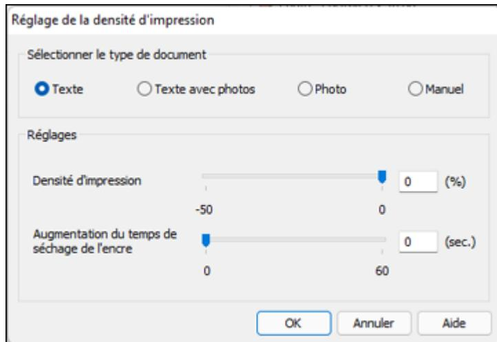
6. Sélectionnez le type de document que vous imprimez pour le paramètre Sélectionner le type de document. Le logiciel règle automatiquement les options Réglages en fonction du type de document.
