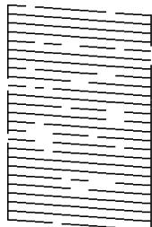
**La tête d'impression a besoin d'un nettoyage puissant.**
