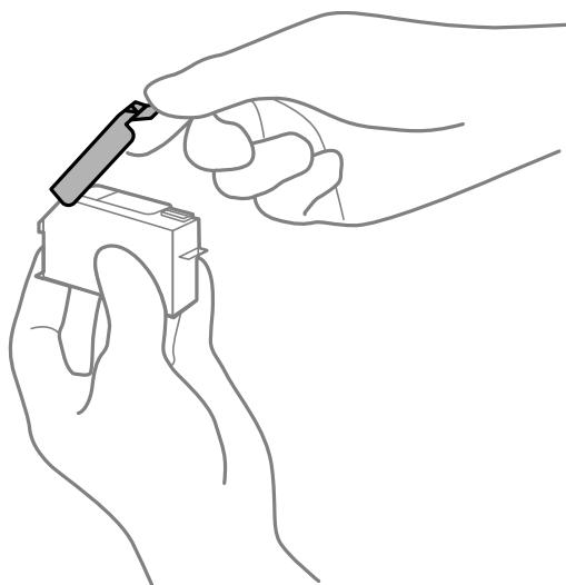
**Mise en garde:** Ne retirez aucune autre étiquette ni aucun ruban d'étanchéité, sinon la cartouche d'encre risque de fuir ou de devenir inutilisable. Ne touchez pas les zones illustrées ici; cela risquerait de nuire à l'impression et au fonctionnement normal du produit.
