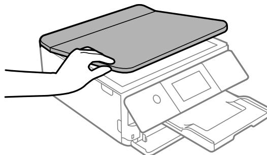
6. Nettoyez la vitre d'exposition du scanner à l'aide d'un chiffon doux et non pelucheux (un chiffon fait de microfibres est recommandé), imbibé d'un peu de nettoyant pour vitres.
