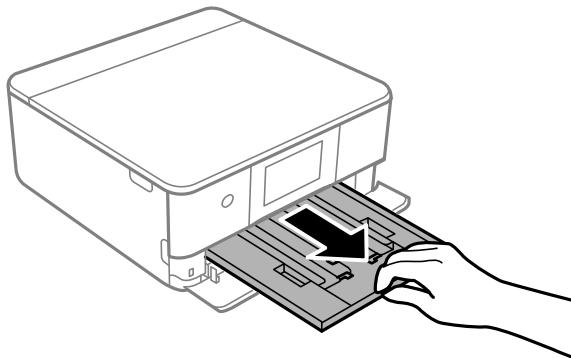
**Remarque:** Si le bac est positionné vers l'arrière de l'imprimante et qu'il est difficile d'accès, mettez l'imprimante hors tension, puis mettez-la sous tension afin de réinitialiser la position du bac.
