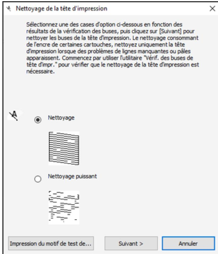
5. Sélectionnez le cycle de nettoyage que vous souhaitez exécuter en vous basant sur le motif de vérification des buses et cliquez sur **Suivant**.
