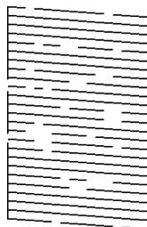
**La tête d'impression a besoin d'un nettoyage puissant.**
