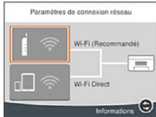
3. Sélectionnez **Wi-Fi (Recommandé) > Changer les paramètres > Autres > Désactiver le Wi-Fi > Commencer la configuration** pour désactiver le Wi-Fi.
