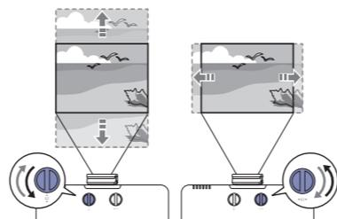
2. Si el proyector está sobre una mesa, puede girar cualquiera de las patas ajustables del proyector para nivelar la imagen.
