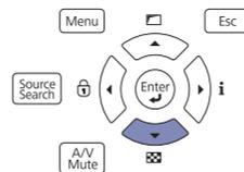
2. Pulse el botón **Enter** para cambiar el patrón de prueba.
