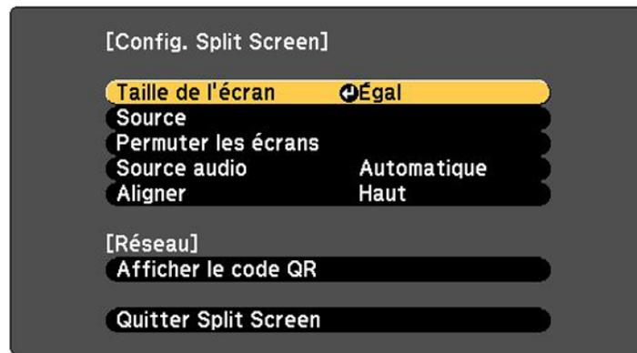
3. Pour sélectionner une source d'entrée pour l'autre image, sélectionnez le paramètre **Source**, appuyez sur **Enter**, sélectionnez la source d'entrée, sélectionnez **Exécuter** et appuyez sur **Enter**. (Au besoin, vous pouvez également modifier les sources d'image.)
