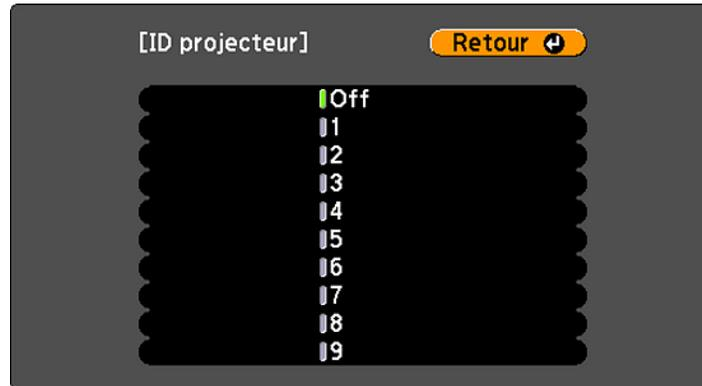
5. Appuyez sur les touches fléchées de la télécommande pour sélectionner le numéro d'identification à utiliser pour le projecteur. Ensuite, appuyez sur **Enter**.
