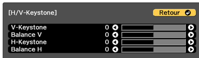
6. Utilisez les touches fléchées sur le projecteur ou sur la télécommande pour sélectionner la correction trapézoïdale verticale ou horizontale ou la correction de balance et pour ajuster la forme de l'image tel que nécessaire.
