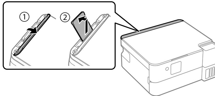
2. Deslice las guías laterales completamente hacia las orillas.
