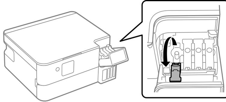
**Nota:** Asegure que el color de la tinta coincida con el color de la etiqueta del tanque de tinta que desea rellenar.
