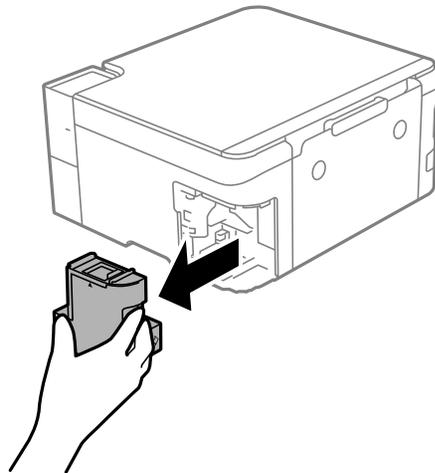
**Nota:** No incline la caja de mantenimiento usada y no la desmonte.
