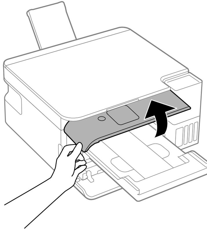
3. Levante la unidad del escáner hasta que encaje en su lugar.
