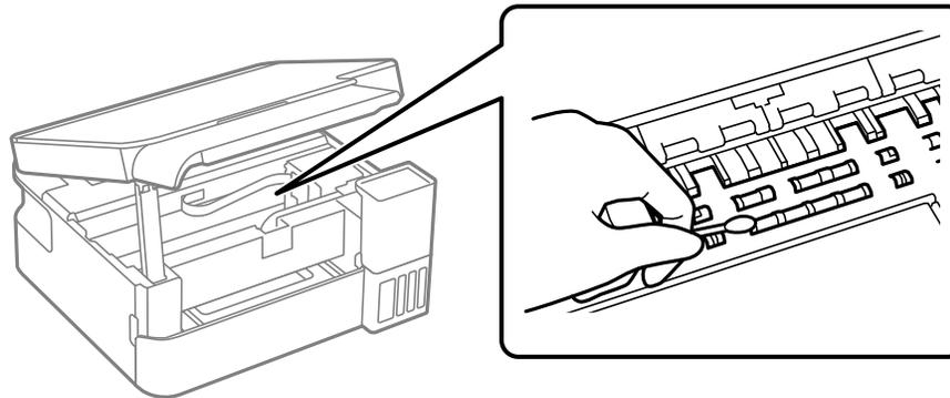
**Precaución:** No utilice pañuelos desechables para limpiar dentro del producto, ya que la pelusa puede obstruir los inyectores del cabezal de impresión. No toque el cable blanco plano, la película translúcida o los tubos de tinta en el interior del producto.
