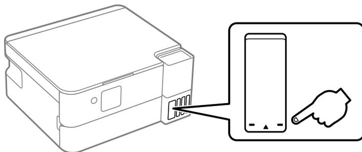
**Nota:** El producto tiene un sistema de alerta que le indica cuando el nivel de tinta está bajo. La precisión del sistema se basa en que los tanques de tinta sean rellenados correctamente. El producto no puede medir los niveles de tinta directamente, sino que calcula la cantidad de tinta restante mediante el conteo interno del uso de tinta. Es posible que el sistema de alerta genere mensajes imprecisos si no llena los tanques de tinta según las instrucciones.
