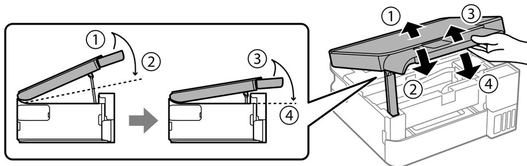
**Nota:** La unidad del escáner está diseñada para cerrarse lentamente y resistir un poco para evitar lastimar los dedos. Continúe cerrando la unidad del escáner aunque sienta algo de resistencia.
