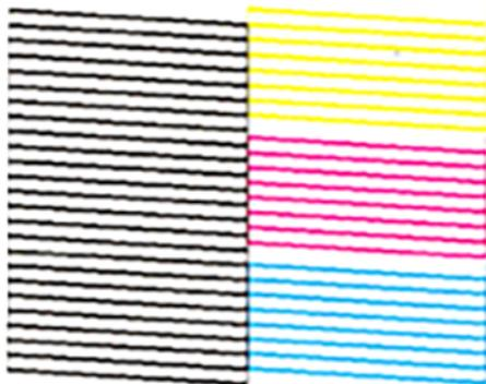
**Necesita limpiar el cabezal de impresión.**
