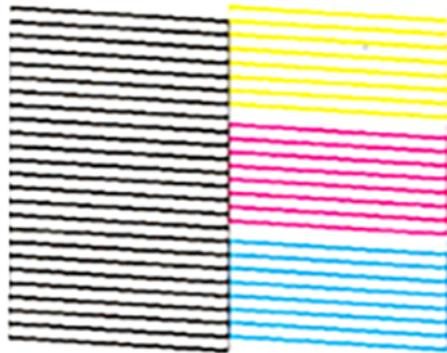
**Necesita limpiar el cabezal de impresión.**
