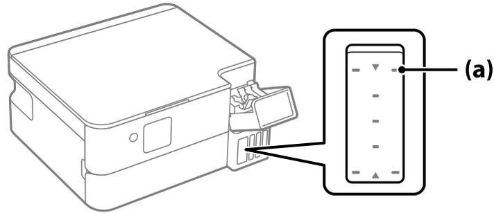
9. Alinee la parte superior de la botella de tinta con el puerto de relleno y luego inserte la botella directamente en el puerto. La tinta fluye en el tanque.
