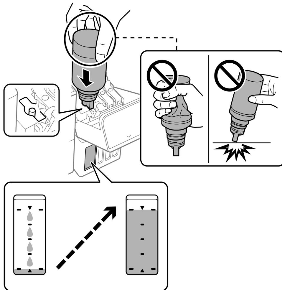
**Nota:** Si la tinta no fluye de la botella, levante y vuelva a insertar la botella. Si la tinta ha alcanzado la línea superior del tanque, no retire y vuelva a insertar la botella; de lo contrario, la tinta se podría derramar.
