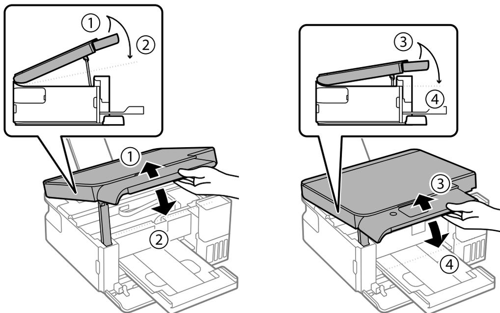
**Nota:** La unidad del escáner está diseñada para cerrarse lentamente y resistir un poco para evitar lastimar los dedos. Continúe cerrando la unidad del escáner aunque sienta algo de resistencia.
