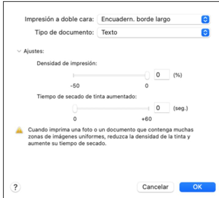
3. Si es necesario, cambie la configuración de los Ajustes, tal como se indica en la pantalla.
