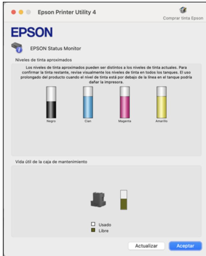
3. Rellene los tanques de tinta o reemplace la caja de mantenimiento, según sea necesario.
