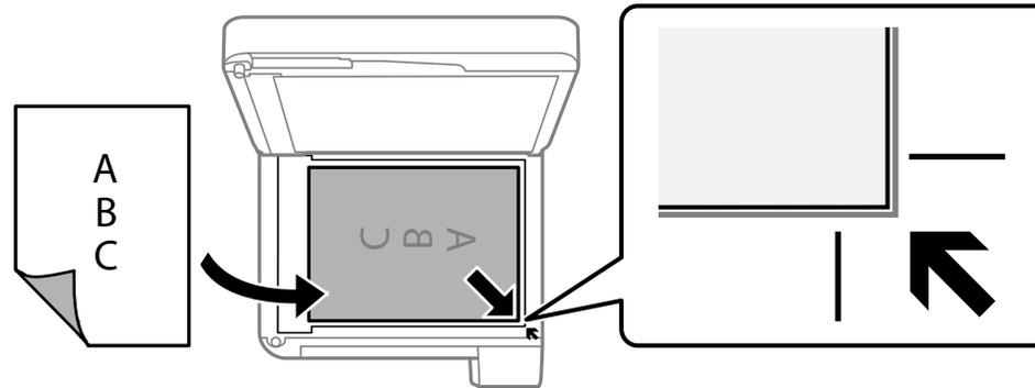
**Nota:** Si está utilizando Epson ScanSmart para escanear varias fotos a la vez, deje una distancia mínima de 0,2 pulg. (4,5 mm) del borde del cristal del escáner y una distancia mínima de 0,8 pulg. (20 mm) entre cada uno.
