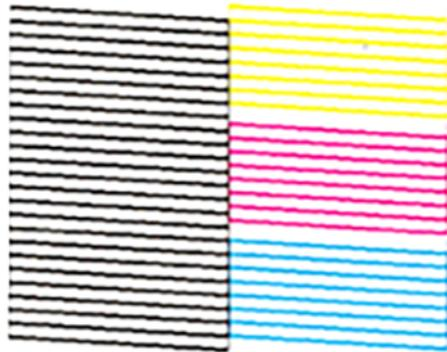
**Necesita limpiar el cabezal de impresión.**
