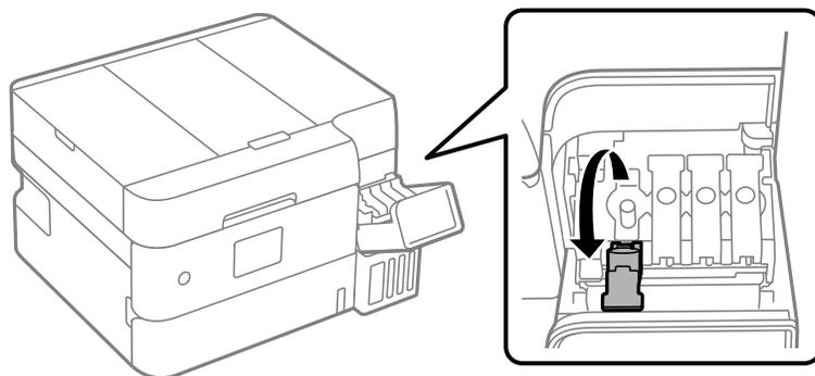
**Nota:** Asegure que el color de la tinta coincida con el color de la etiqueta del tanque de tinta que desea rellenar.
