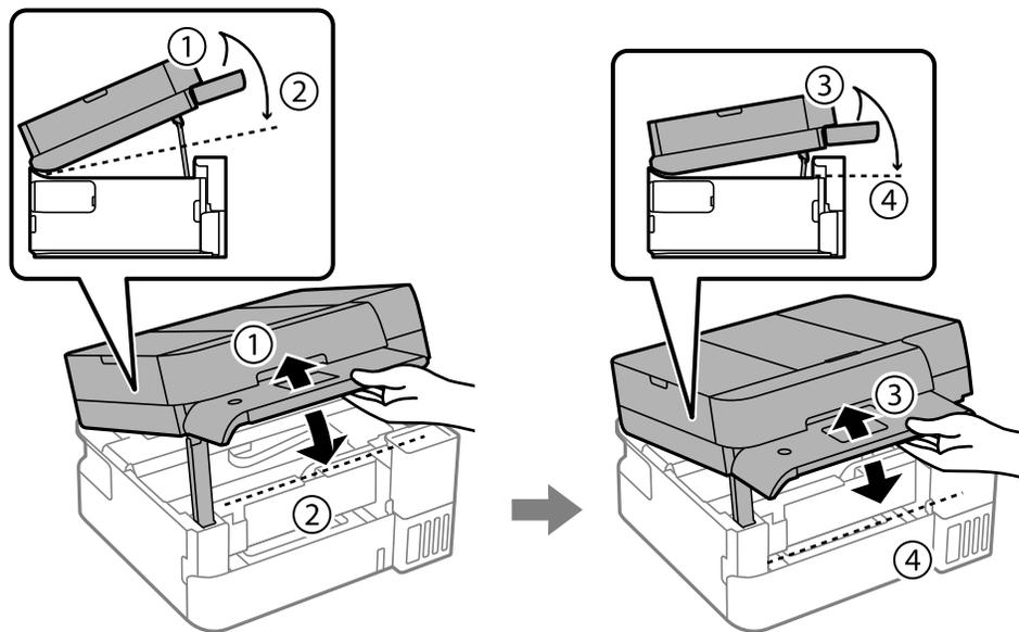
**Nota:** La unidad del escáner debe estar completamente cerrada antes de que la pueda abrir de nuevo.
