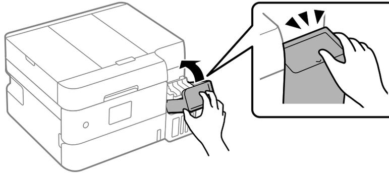
**Nota:** La unidad del escáner está diseñada para cerrarse lentamente y resistir un poco para evitar lastimar los dedos. Continúe cerrando la unidad del escáner aunque sienta algo de resistencia.
