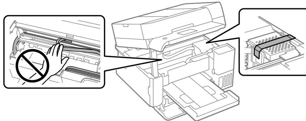
**Nota:** Asegúrese de colocar la cinta adhesiva, tal como se muestra a continuación, sin tapar los orificios; de lo contrario, no podrá cerrar la unidad del escáner.
