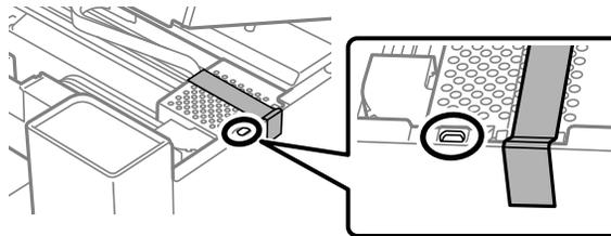
10. Cierre la unidad del escáner. Por seguridad, la unidad del escáner se cierra en dos pasos.
