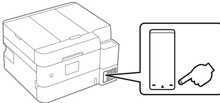
**Nota:** El producto tiene un sistema de alerta que le indica cuando el nivel de tinta está bajo. La precisión del sistema se basa en que los tanques de tinta sean rellenados correctamente. El producto no puede medir los niveles de tinta directamente, sino que calcula la cantidad de tinta restante mediante el conteo interno del uso de tinta. Es posible que el sistema de alerta genere mensajes imprecisos si no llena los tanques de tinta según las instrucciones.
