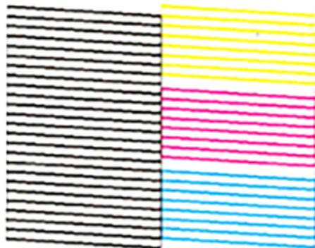
**Necesita limpiar el cabezal de impresión.**
