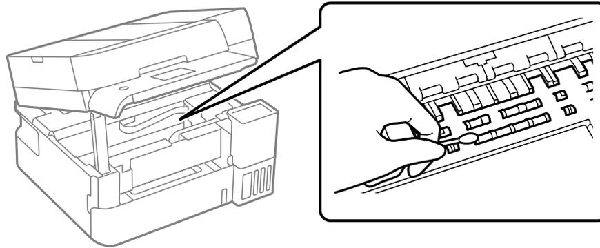
**Precaución:** No utilice pañuelos desechables para limpiar dentro del producto, ya que la pelusa puede obstruir los inyectores del cabezal de impresión. No toque el cable blanco plano, la película translúcida o los tubos de tinta en el interior del producto.
