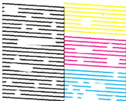
**Necesita limpiar el cabezal de impresión con una limpieza a fondo.**
