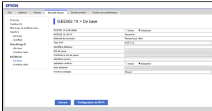
3. Sélectionnez **Activer** au paramètre **IEEE802.1X (LAN câblé)**.
