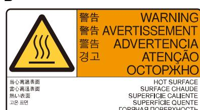
La surface du manipulateur est chaude pendant et après le fonctionnement, et il existe un risque de brûlure.
