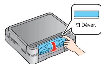
**Mise en garde :** Pour éviter d'endommager l'appareil Artisan 700 Series, appuyez toujours sur le bouton Déverrouiller pour incliner le panneau de commande vers le bas.
