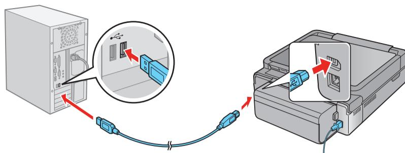
**Remarque :** Si l'installation ne se poursuit pas après un moment, assurez-vous d'avoir correctement branché le câble USB et mis sous tension l'appareil Artisan 710 Series.
