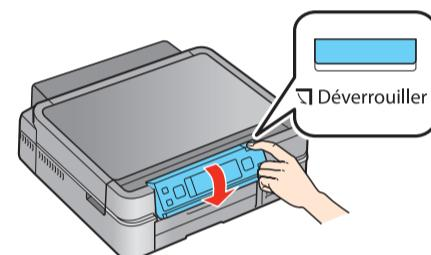
**Mise en garde :** Pour éviter d'endommager votre appareil Artisan 710 Series, appuyez toujours sur le bouton Déverrouiller pour incliner le panneau de commande vers le bas.
