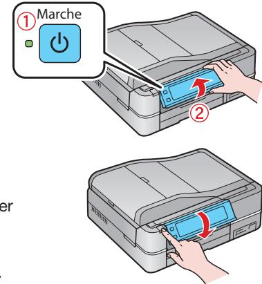
**Mise en garde :** Pour éviter d'endommager votre appareil Artisan 810 Series, appuyez toujours sur le bouton **Déverrouiller** pour incliner le panneau de commande vers le bas.
