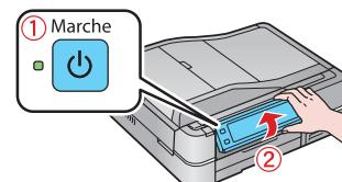
**Mise en garde :** Pour éviter d'endommager l'imprimante, appuyez toujours sur le bouton Déverrouiller pour abaisser le panneau de commande.
