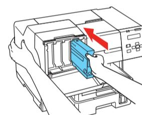
5 Après avoir installé les 4 cartouches, abaissez le levier des cartouches en position de verrouillage.
