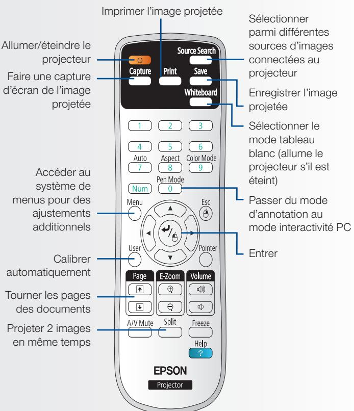
Pour plus d'informations sur la façon d'utiliser la télécommande, consultez le *Guide de l'utilisateur* en ligne. Vous pouvez installer un lien vers le *Guide de l'utilisateur* en insérant le CD BrightLink Pro 1410Wi. Ou consultez le site Web [epson.com/brightlinkdownloads](http://epson.com/brightlinkdownloads) (É.-U.) ou [epson.ca/brightlinkdownloads](http://epson.ca/brightlinkdownloads) (Canada).
