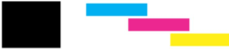
Si la página de prueba no se imprime correctamente, significa que hay un problema en el equipo. Por ejemplo: si aparecen bandas en el patrón de comprobación como se muestra a continuación, puede que uno de los inyectores de tinta esté obstruido o que el cabezal de impresión esté desalineado. Si desea obtener más detalles sobre la limpieza de cabezales, consulte la sección [Limpieza de los cabezales de impresión](#).
