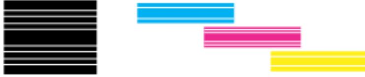
Si la página de prueba de inyectores no se imprime correctamente, significa que hay un problema en el equipo. Podría tratarse de un inyector de tinta obstruido o de un cabezal de impresión desalineado. Si desea obtener más detalles sobre la limpieza de cabezales, consulte la sección [Limpieza de los cabezales de impresión](#).
