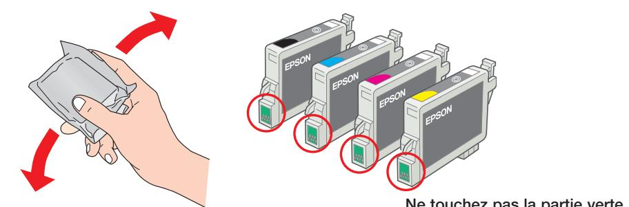
**Mise en garde :** Vous devez installer toutes les cartouches et les laisser dans l'appareil pour tous les types de travaux. Pour éviter d'endommager l'appareil, ne déplacez jamais manuellement la tête d'impression.
