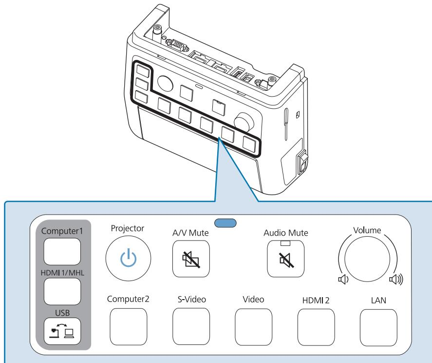
Appuyez sur les boutons de source d'entrée pour entrer les images et l'audio de l'appareil connecté sur le port, comme indiqué dans le tableau suivant.
