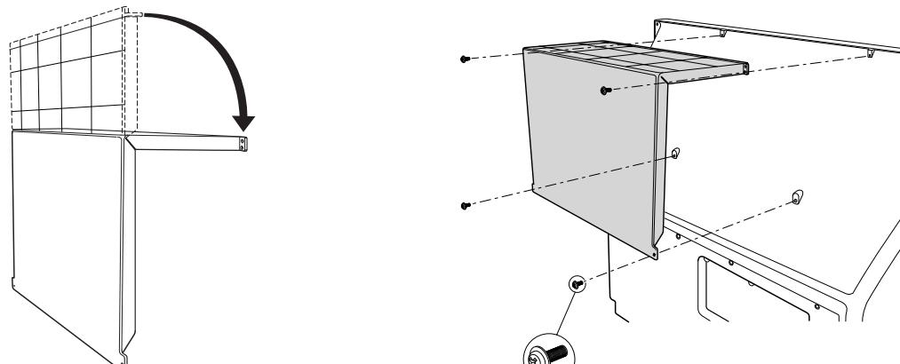
3 À l'aide d'un tournevis Phillips, fixez l'étagère au téléviseur à l'aide des quatre vis fournies. Serrez les vis.
