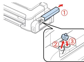
Abra la unidad del tanque de tinta y luego retire el tapón del tanque.
