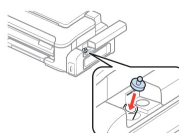
Coloque el tapón del tanque de tinta firmemente.
