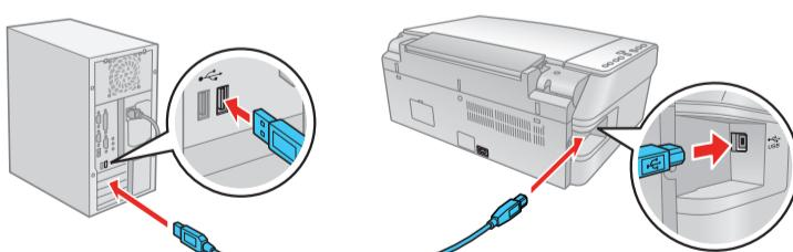
**Remarque :** Si l'installation ne se poursuit pas après un moment, assurez-vous d'avoir correctement branché et mis sous tension l'appareil NX200.
