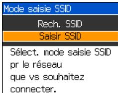
9. Utilisez les boutons à flèche sur le panneau de commande de l'imprimante pour saisir le nom du réseau sans fil (SSID). Appuyez sur le bouton **☰ Menu** pour choisir des lettres majuscules ou minuscules, ou des chiffres/caractères spéciaux.
