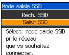
9. Utilisez les boutons à flèche sur le panneau de commande de l'imprimante pour créer un nom de réseau unique (SSID) afin d'identifier votre imprimante. Appuyez sur le bouton
