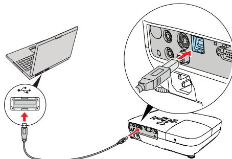
**Windows®** : Après avoir mis le projecteur sous tension, suivez les directives à l'écran pour installer le logiciel Epson USB Display (EMP\_UDSE.EXE; seulement lors de la première connexion).
