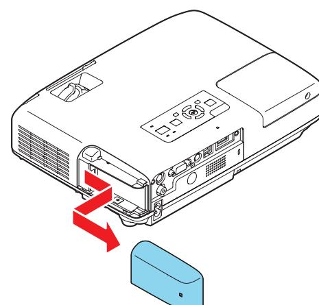
**3** Installez le module sans fil. Remettez le couvercle en place à l'aide des vis.
