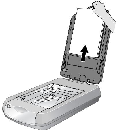
3. Si vous numérissez des bandes de film ou des négatifs, ouvrez le couvercle du support, placez la bande de film dans le support approprié, côté support du film vers le bas. (Si vous numérissez des diapositives, passez à l'étape 6.)
