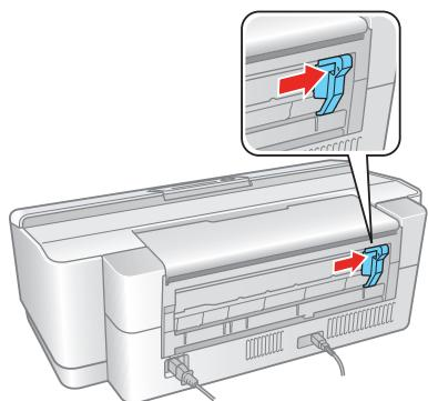
**4** Fixez le guide d'alimentation de feuilles individuelles en alignant les coches de sa base avec les fentes situées dans le bas de l'imprimante. Ensuite, accrochez les languettes au-dessus de la fente (marquée par des triangles orange).
