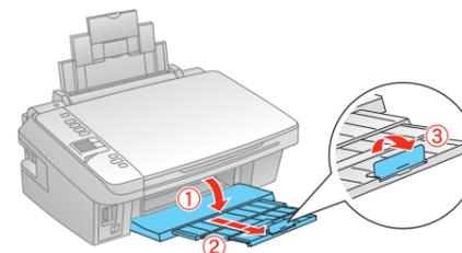
3 Aperte a guia da borda e deslize-a completamente para a esquerda.
